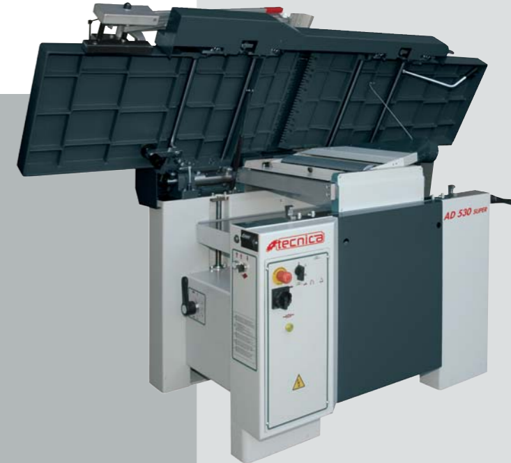
Apertura automatica piane filo Automatic opening of planing tables Automatische Aufklappen der Abrichttische Ouverture automatique des tables Abertura automatica de las mesas del cepillo
