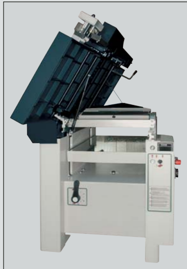
Sollevamento automatico spessore Automatic thicknessing-table lifting Automatische Dickeneinstellung Table du rabotage Subida automatica regruesadora
