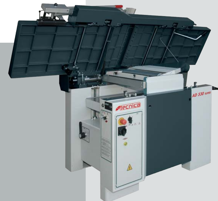
Apertura automatica piane filo Automatic opening of planing tables Automatische Aufklappen der Abrichttische Ouverture automatique des tables Abertura automática de las mesas del cepillo
