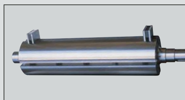
Registrcottelli magnetico Magnetic knife adjuster Magnetische Messereinstellehre Appareil magnétique de réglage des couteaux Regulador de cuchillas magnético
